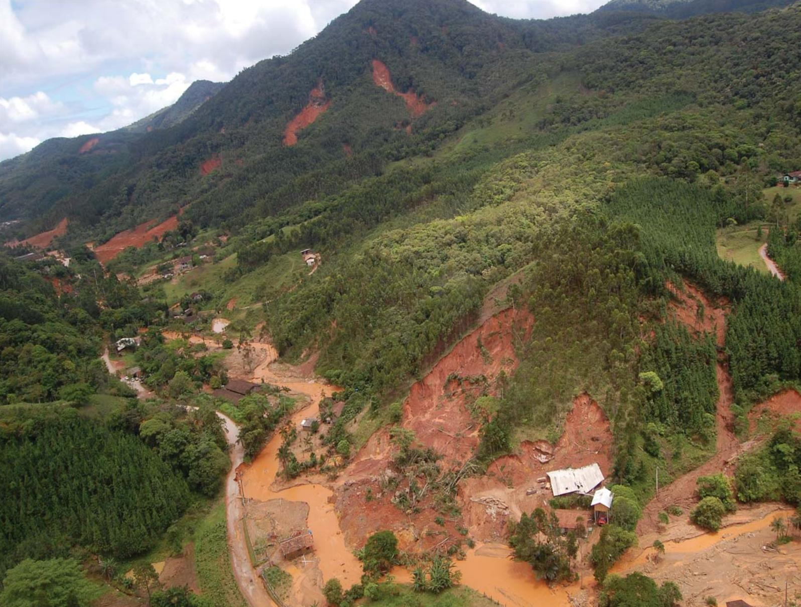
Figura 27 -Uso intensivo e extensivo do solo em encosta inclinada, aumentando o desastre ambiental, Baú Alto, Ilhota novembro de 2008. Foto: Fábio Faraco.
